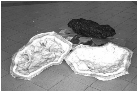
Fig. 4. Dwie połówki formy silikonowo-żywicznej, dające możliwość wykonywania repliki z największego okazu meteorytu Morasko.
