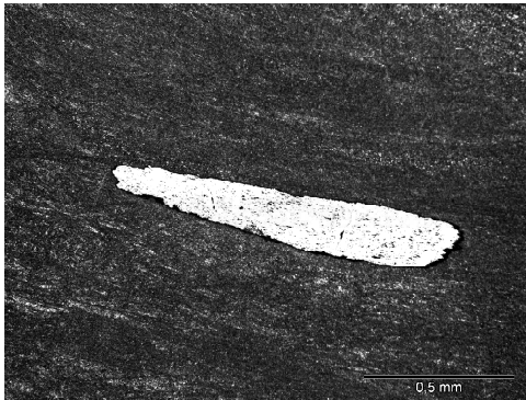
Fig. 5. Wydłużona inkluzja troilitu (jasna) tkwiąca w kamacycie z zaznaczoną teksturą kierunkową. Światło odbite, jeden nikol, powierzchnia trawiona nitałem.
