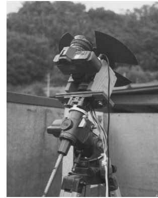
Rys. 17. Kamera Canon T 70 z wirującym sektorem.
