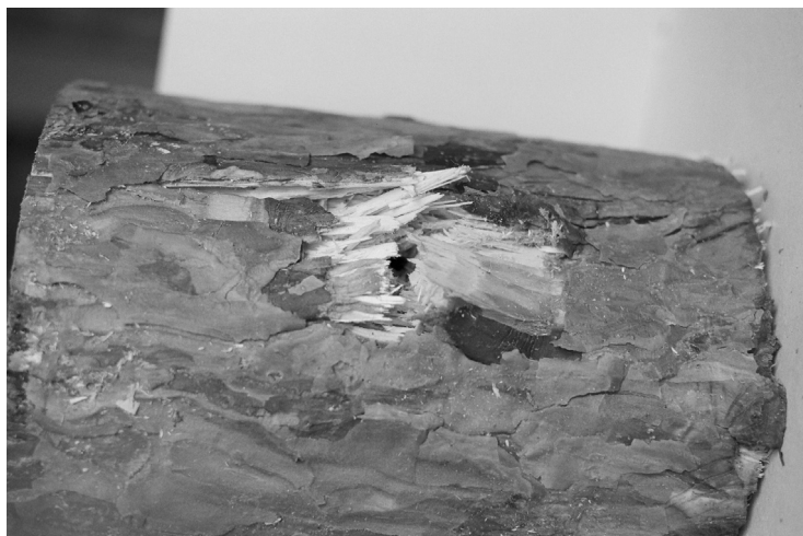
Fot. 12. Drzewo po wbiciu pocisku ołowianego z prędkością \sim 400 m/s – duże zniszczenie tkanki drewna.
