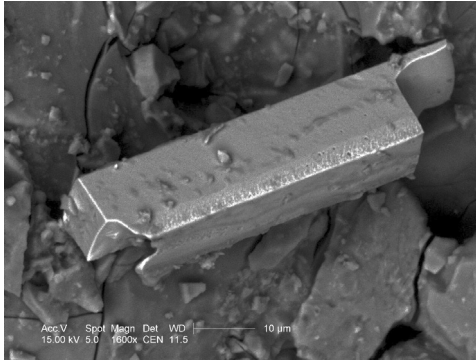
Fot. 7. Kryształ rhabdytu wśród wodorotlenków żelaza i niklu. Silnie zwietrzały meteoryt Morasko. Mikroskop skaningowy.
